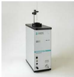
気流用校正装置として、完全自動化に対応したStreamLinePro校正装置と最大60m/secまでの校正に対応した2点校正装置の2種類があります。StreamLinePro校正装置は、StreamWareから制御されることにより、ユーザが指定した範囲の校正を自動で行うことが可能です。2点校正装置は、校正範囲が固定されることにより、最低流速と最大流速の2点の校正を行うことにより簡易にワイヤープローブを利用することが可能となります。
