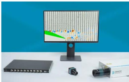
65mJ@15Hzのダブルパルスレーザ、1.3Mピクセルカメラ、50mmレンズ、タイミングユニット、ソフトウェアをパッケージにした、コンセプトシステムです。カメラ1台による2次元計測システムとカメラ2台を利用したステレオ3次元計測システムの2種類が準備されています。計測に必要な基本システムがパッケージで提供されますので、お手持ちのWindows10が動作するコンピュータへインストールすることにより直ぐにご利用になることができます。
