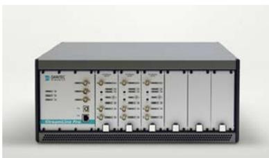
熱線流速計を利用する多くのアプリケーションにおいて、高い性能と安定した計測を可能とする高スペックシステムです。システムは全て専用ソフトウェアであるStreamWare Proから行われ、計測に応じた詳細なパラメータ設定を可能とします。USBもしくはネットワークケーブルによってコンピュータと接続されたメインフレームには、環境温度モニタリング用のサーミスタ温度計を有し、ソフトウェア上において環境温度の補正を行う
