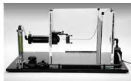
大がかりな水流用の校正装置を構築することなく、簡単にジェット流によりプローブの校正を可能とします。ジェット流の流速を変更することによって簡単に所定の流速を提供します。
