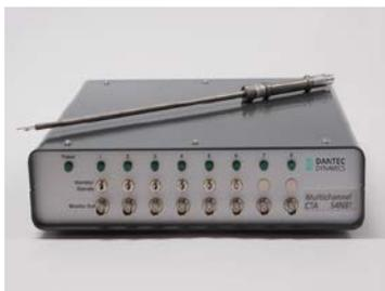
MiniCTAと同一のブリッジ回路を有した他点計測に対応した装置です。内部に複数の独立した回路を有しているため、多点同時計測を容易に行うことができます。
