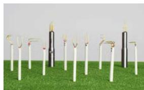
熱線流速計におけるプローブの選択は重要な要素のひとつとなります。標準品の他、ユーザの要望に応じた特殊プローブの制作にも対応し、アプリケーションひとつひとつに合わせたプローブの選択が可能となっています。
