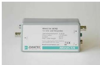
筐体内に計測のためのブリッジ回路、簡易なバンドパスフィルタ及びゲイン・オフセット機能を有したコンパクトな熱線流速計装置です。内部ディップスイッチの切り替えによって多様なプローブを用いた計測に対応し、気流・水流のいずれの計測においても利用が可能です。
