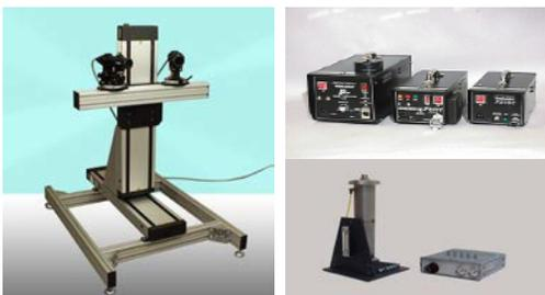
点計測であるレーザー流速計においてマッピング計測を可能とするための装置として、トラバース装置が利用されます。測定範囲に応じたストロークを準備することができ、ソフトウェアによる自動計測に対応します。計測に必要なとされるシーディング粒子の発生装置も噴霧や煙粒子、固体粒子なども準備されており、アプリケーションに合わせた発生装置の選択が可能です。
